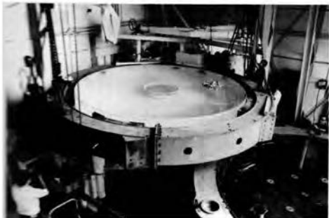
Fabrication du miroir primaire ( \varnothing 3,60 m) du télescope Ritchey-Chrétien de l'European Southern Observatory installé au Chili (1969).
