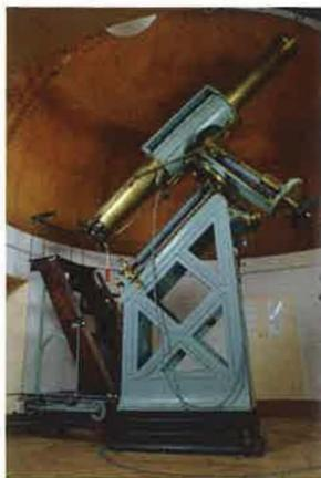
Lunette astronomique installée en 1872 équipée d'une monture équatoriale due à Wilhelm Eichens et d'un objectif de 26 cm de diamètre provenant de l'atelier munichois G. und S. Merz.
