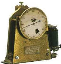
Horloge astronomique Leroy ; le cadran muni d'une seule aiguille indique les secondes
