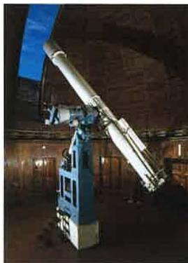
La petite lunette équatoriale de 7,50 m de distance focale est aujourd'hui équipée d'un objectif de 50 cm de diamètre.
