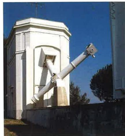
riaux et leurs coupoles. L'un est un chercheur de comètes de 25 cm de diamètre et 1,80 m de distance focale ; cette lunette sert actuellement de chercheur à la grande lunette équatoriale. L'autre est un astrographe muni de deux lunettes photographiques de 40 cm de diamètre et 2 m de distance focale. L'architecte niçois Honoré Aubert construit les bâtiments qui les abritent.
