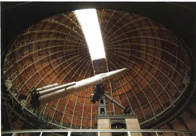
Le retrait de l'abri roulant laisse apparaître la lunette équatoriale coudée. Des sept instruments de ce type construits entre 1884 et 1892, celui de Nice est le plus grand encore en place et le seul en état de fonctionnement.
