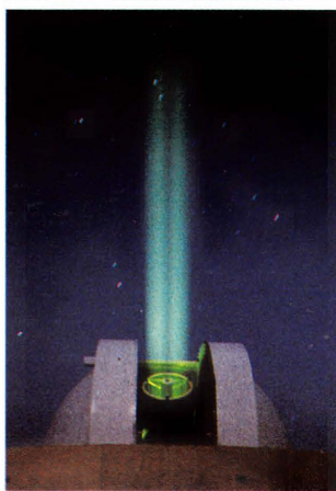
Tir laser vers la Lune à l'aide du télescope de 1,50 m de diamètre.
