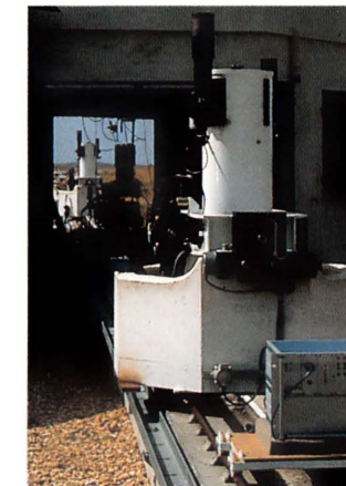
Configuration générale du petit interféromètre du plateau de Calern.
